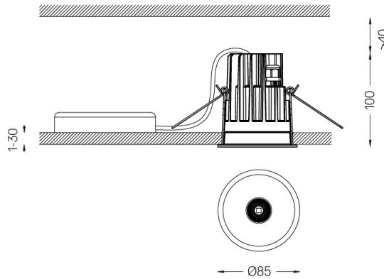
**Optional****59014 Zubehör 12,5mm Decken (flush Einbau)**
