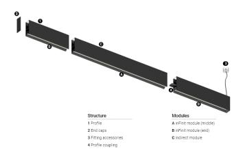
Design: OM + Bartenbach GmbH Modul mit extrudierten Linearlinsen (Lightstream) in Verbindung mit einem Zweitreflektor, eingebaut in ein extrudiertes Aluminiumprofil.
