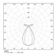
Abstrahlwinkel Flood 64° / batwing Anwendung
