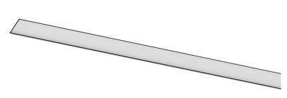
Diseño: Eduardo Souto de Moura Luminaria empotrable sin embellecedor con carcasa de perfil de aluminio con anodizado de 25 micrómetros, que ofrece la máxima resistencia contra la corrosión, con acabado mate o de pintura electrostática texturizada 100 % poliéster Difusor de policarbonato esmerilado con sistema de enganche fácil y sistema de montaje doble: enrasado o empotrado.
