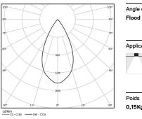
Angle du faisceau Flood 52° Application 0,15Kg
