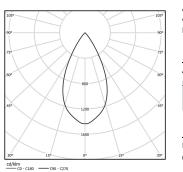
Angle du faisceau Flood 52° Application Poids 0,22Kg
