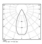
Angle du faisceau Flood 59° Application Poids 0,64Kg
