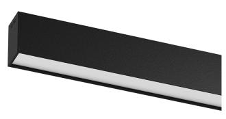
Conception : Eduardo Souto de Moura Luminaire en applique ou suspendu doté d'un boîtier en profilé en aluminium avec anodisation de 25 microns de résistance maximale à la corrosion en finition mate ou peinture électrostatique 100 % polyester en finition texturée.
