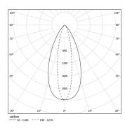
Angle du faisceau Elliptical 22×47°
