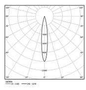
Angle du faisceau Spot 15° Application Poids 0,64Kg
