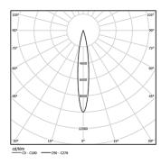
Angle du faisceau Spot 15° Application Poids 0,64Kg
