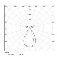
Angle du faisceau Flood 64° / batwing
