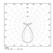
Angle du faisceau Flood 64° / batwing Application
