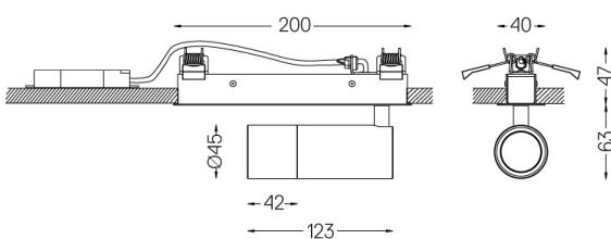
Dimensões do rasgo de encastramento para tetos em pladur. Para outros materiais, por favor, contacte: support@om-light.com
